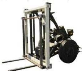
**Адаптеры производства компании Kron Investment Group s.r.o.** предназначены для транспортировки и перевозки блок- и кузов-контейнеров, а также их частей и модулей на производстве и на складе во время отгрузки и выгрузки изделия. Адаптеры по своей конструкции схожи с рохлей или погрузчиком.
