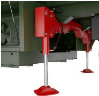
Автоматическая система вывешивания и горизонтирования КРОН-СВГ предназначена для подъема и опускания кузов-фургонов, а также его выравнивания относительно поверхности земли.
